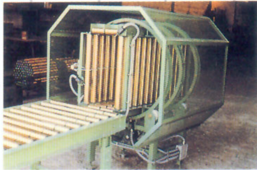
Volteador automático en proceso de embalajes.
