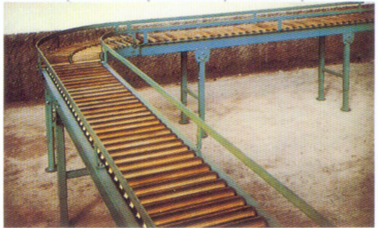
Transporte por gravedad con curva de rodillos cilíndricos dobles.
