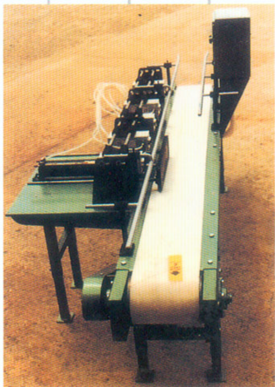
Transportador especial para proceso automático de montaje.
