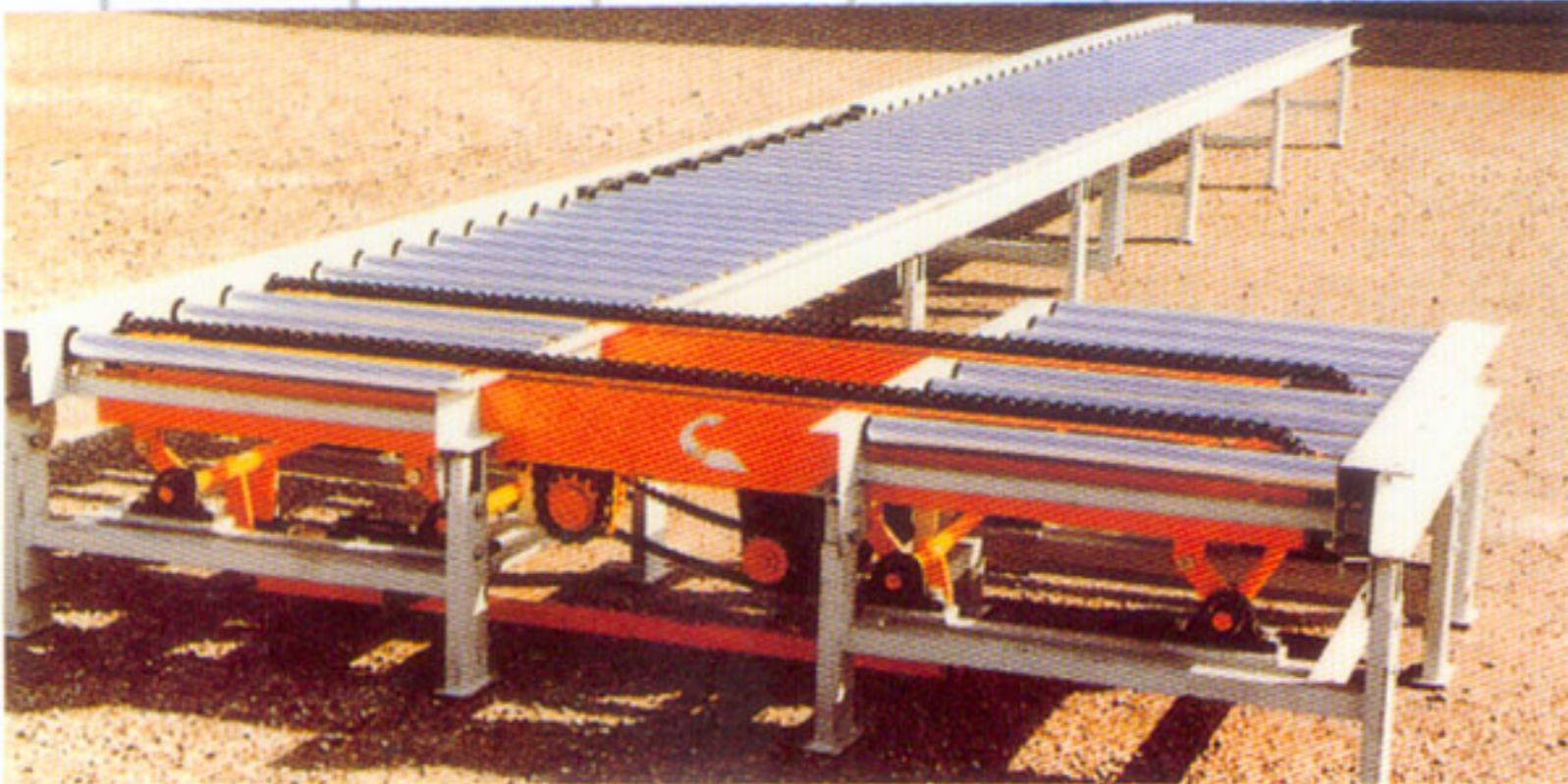
Transportador con rodillos accionados - acumuladores y transfer por cadena.
