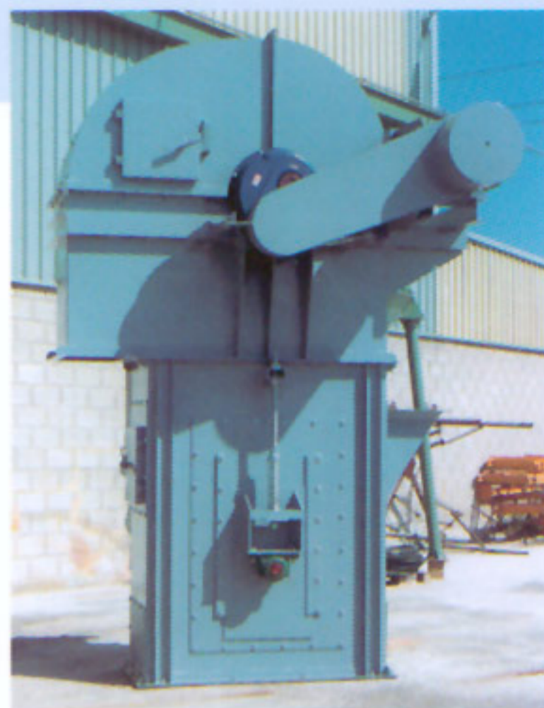
Detalle cabezales de carga-tensor y descarga-motriz.
