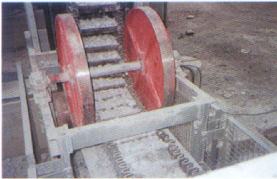
Detalle en carga de zona de inflexión TEB .
