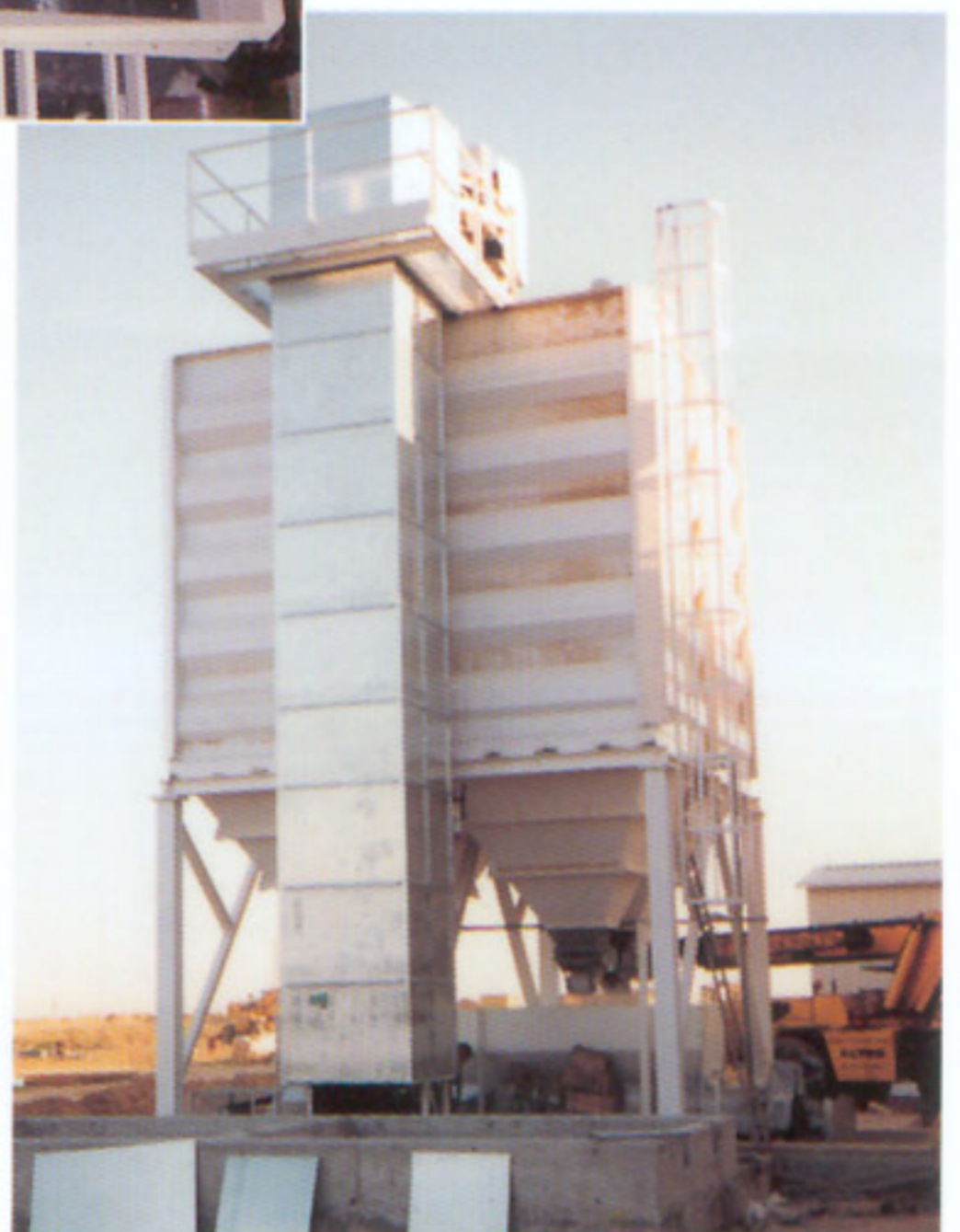
TEB para extracción desde 33 m de profundidad de excavación en túnel colector, con tolva y sistema para carga de camiones.
