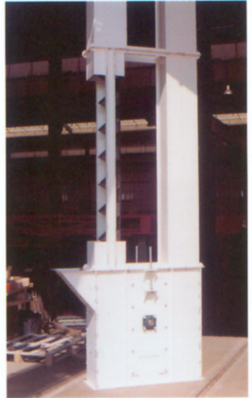
Tramo intermedio con tapas desmontables para montaje y mantenimiento de cangilones.
