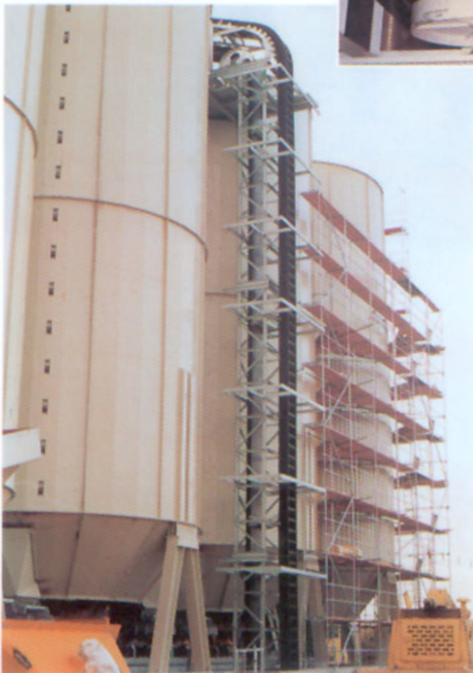
Elevadores TEB para llenado de diversos productos en silos de almacenaje.
